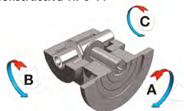
Movimiento de la forma constructiva TIPO 14
