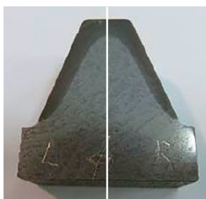
Templado por inducción satisfactorio y deficiencias en el rectificado de los dientes.
