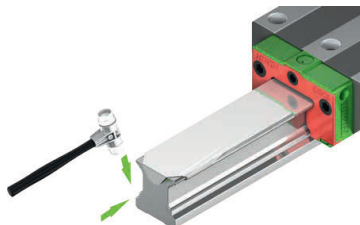
Imag. 5.35 Doblando los extremos de la cinta de recubrimiento
