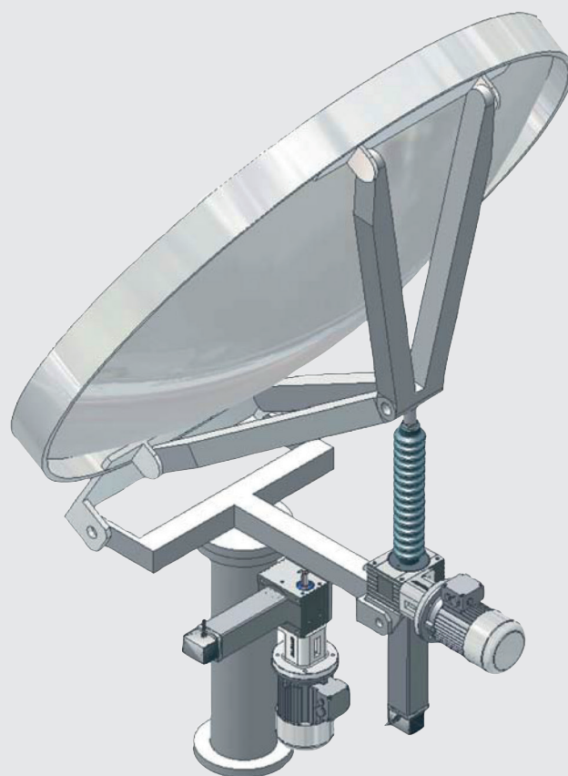
Antena parabólica D = 3,3 \text{ m} , ambos ejes – acimut + elevación – 50 \text{ kN c/u} , recorrido de ajuste por cada movimiento 0,02 - 0,05 \text{ mm} ; las instalaciones se encuentran al aire libre en una zona costera
